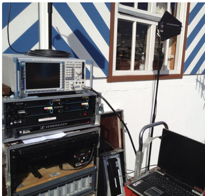
Bild 3: Scanempfänger, Antenne und Laptop zur Aufzeichnung
