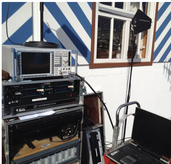
Bild 3: Scanempfänger, Antenne und Laptop zur Aufzeichnung
